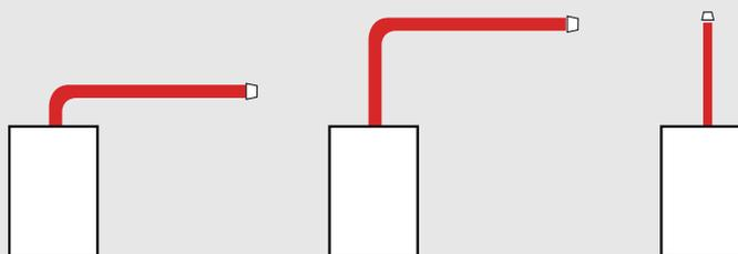
La versión Tiro Forzado utiliza un tubo de escape de aluminio de 60 mm de diámetro. También es necesario contar con entrada de aire para el local donde está instalada la caldera para la correcta combustión.
